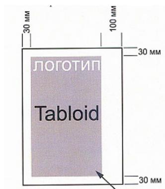
Точность позиционирования по длинной стороне: +/- 10 мм
